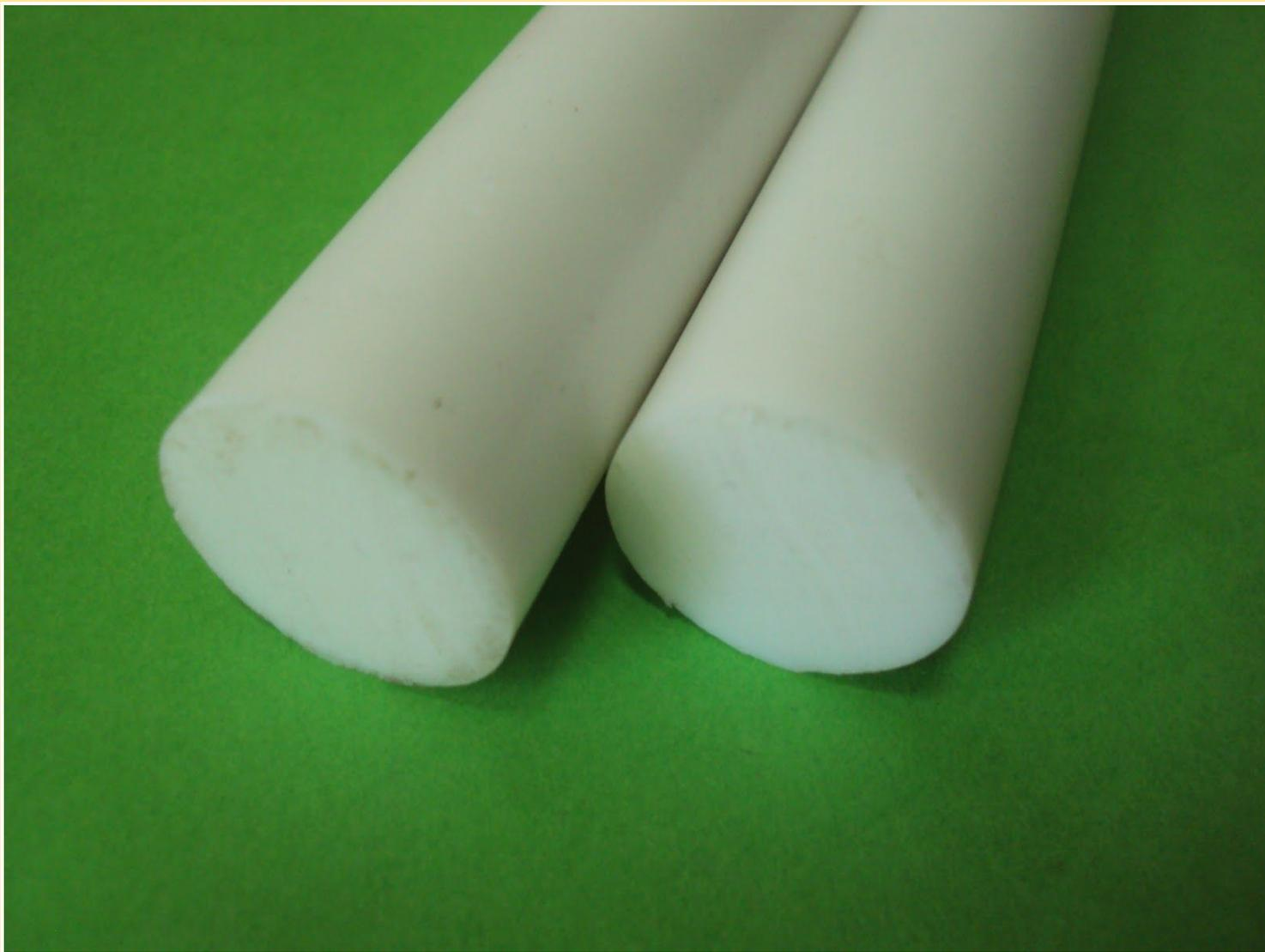
**Фторопласты (фторлоны)** — техническое название фторсодержащих полимеров в СССР, РФ. К фторопластам относятся политетрафторэтилен — фторопласт-4, политрифторхлорэтилен — фторопласт-3, поливинилиденфторид — фторопласт-2, а также сополимеры фторпроизводных этилена с фторолефинами, этиленом и др.
